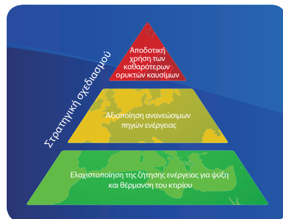
Απεικόνιση Στρατηγικής για Ενεργειακό & Περιβαλλοντικό Σχεδιασμό και των αντίστοιχων Τεχνολογιών που εφαρμόζονται (Heiselberg et al. 2006)
